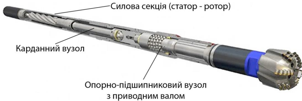
Рисунок 1 – Типова конструкція гвинтового вибійного двигуна та його основні вузли [4]
