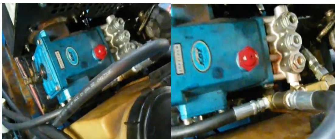
1 – всмоктувальна лінія від насоса високого тиску; 2 – нагнітальна лінія на оливо-рідинний теплообмінник; 3 – нагнітальна лінія на повітряно-рідинний радіатор охолодження Рисунок 5 – Зовнішній вигляд (а) та під'єднання (б) змонтованого додаткового оливного насоса в агрегат для гідравлічного розриву пластів
