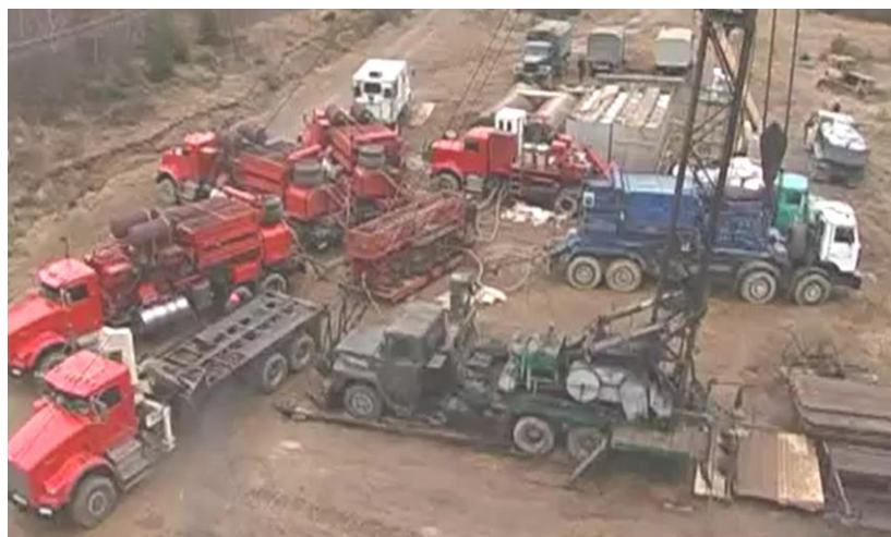
Рисунок 7 – Проведення промислових випробувань на базі мобільного агрегату для гідравлічного розриву пластів мод. FC-2251
