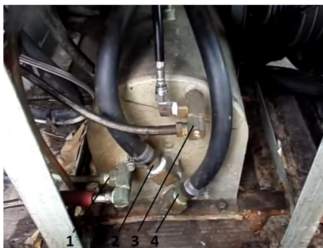
1 – вхідна лінія холодної оливи; 2 – вихідна лінія охолоджувальної рідини; 3 – вихідна лінія підігрітої оливи; 4 – вхідна лінія охолоджувальної рідини Рисунок 6 – Зовнішній вигляд змонтованого оливо-рідинного теплообмінника в агрегат для гідравлічного розриву пластів
