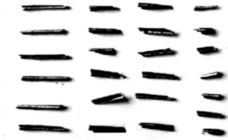
Рисунок 5 – Форма стружки, що утворюється пластиною з криволінійною передньою поверхнею збірної черв'ячної фрези при обробці зубчастого вінця ( m = 20 мм; z = 316 , матеріал – сталь 34ХНЗМА)
