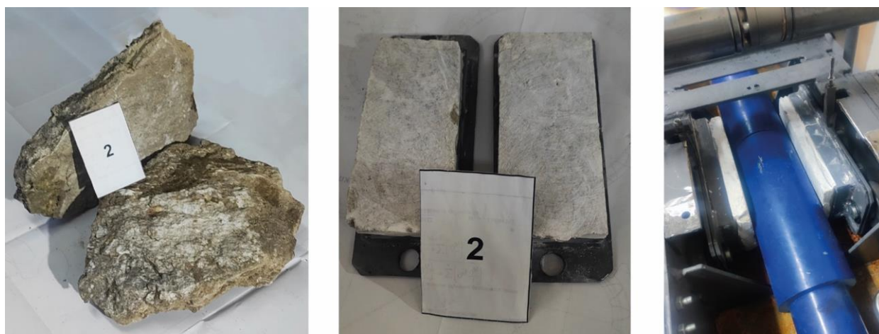
А – відібраний зразок гірської породи; Б – вирізані та вклеєні у породотримачі зразки; В – породотримачі із зразками породи, встановлені на столи в лабораторній установці Рисунок 5 – Етапи підготовки гірської породи до експерименту
