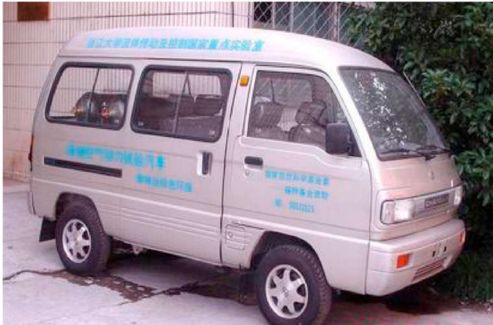
Рисунок 5 – Перший транспортний засіб зі стисненим повітрям у Китаї, розроблений та випробуваний в університеті Zhejiang
