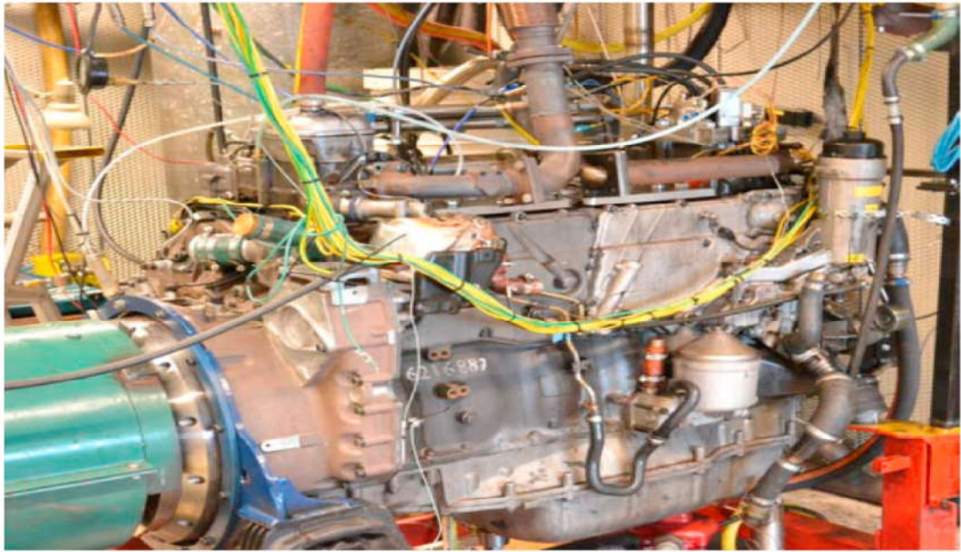
Рисунок 6 – Модифікований гібридний двигун на стисненому повітрі Scania D12
