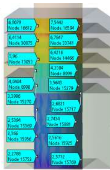
Рисунок 11 – Розподіл контактної тиску по поверхні контакту «шток-манжета» із використанням маркерів
