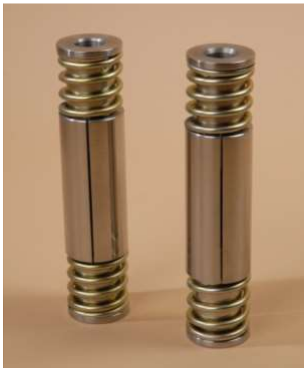
а – принципова схема демпфера; б – натурні взірці; 1, 7 – поршні; 2, 6 – гвинтові пружини тискування; 3 – оболонка з розрізом уздовж твірної; 4 – слабкостисливий деформівний заповнювач; 5 – стовбур
