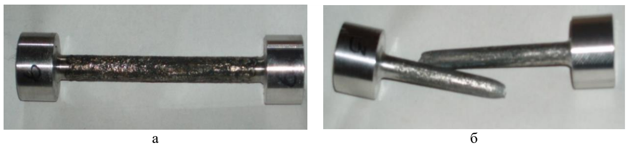
Рисунок 3 – Зразок зі сталі 40Х до (а) і після (б) випробування на розрив
