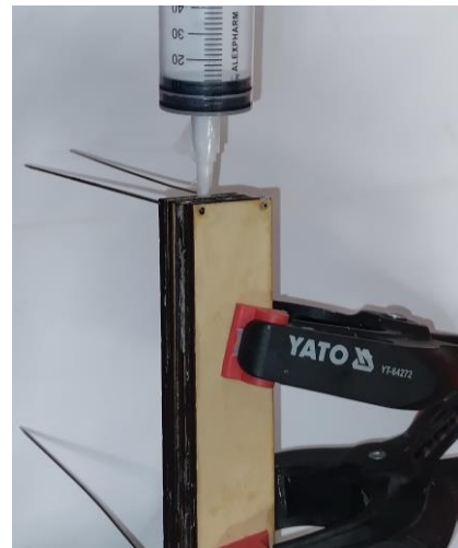
Рисунок 9 – Заповнення форм за допомогою циліндра
