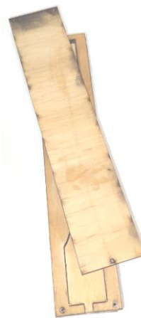
Рисунок 3 – Компоновка елементів форми для виготовлення дослідних зразків
