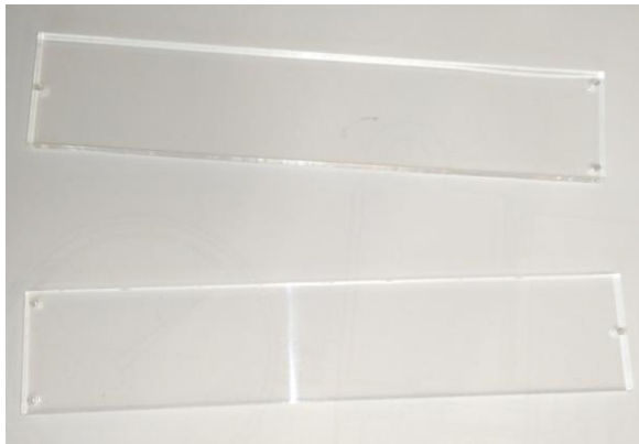
Рисунок 7 – Елементи форми для дослідного зразка, виготовлені із оргскла
