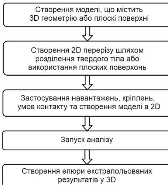
Рисунок 3 – Алгоритм імітаційного моделювання при використанні осесиметричної моделі сільфону
