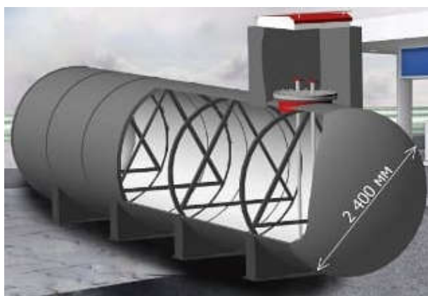
Рисунок 1 – Типова конструкція резервуару
