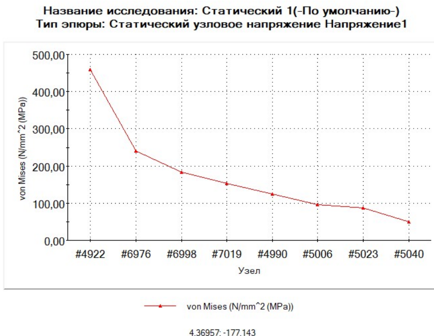
Рисунок 13 – Графічні залежності розподілу еквівалентних напружень по впадинах витків ніпеля
