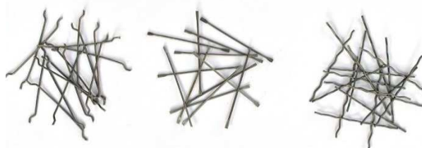
Рисунок 1 – Види фібр: анкерна, плющена, хвиляста
