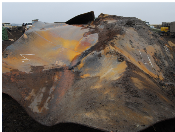
Рисунок 3 – Характерний приклад гільйотинного руйнування труби газопроводу “Уренгой – Помари – Ужгород” (2007 р.)
