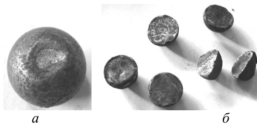
а – сколювання фрагменту; б – розколювання кульок навпіл і на декілька частин
