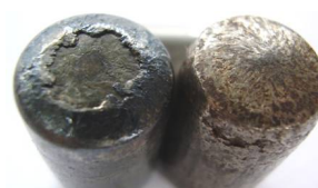
Рисунок 2 – Знос і деформація торців роликів з подальшим загостренням в основі
