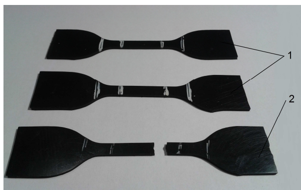
а – конструктивні особливості, б – загальний вигляд: 1 – зразки до розриву; 2 – зразок після розриву
