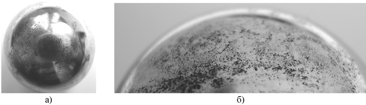
а) а – загальний вигляд зношеної кульки; б) б – збільшений вигляд в зоні інтенсивного корозійно-втомного руйнування кульки \times 4p
