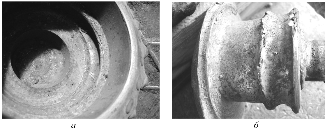
а) а – зношування бігової доріжки шарошки; б) б – зношування бігової доріжки на опорі
