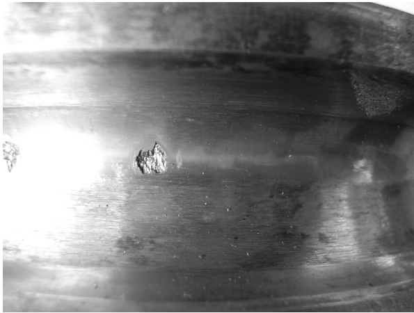
Рисунок 4 – Слід глибинного схоплення в центральній частині жолоба бігової доріжки
