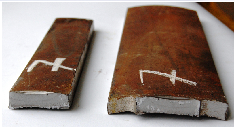
Рисунок 2 – Зразок з концентратором
