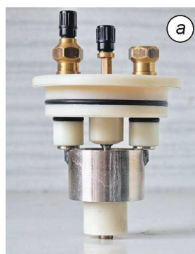
1 – робочий електрод (зразок); 2 – допоміжний електрод; 3 – клема допоміжного електрода; 4 – клема робочого електрода
