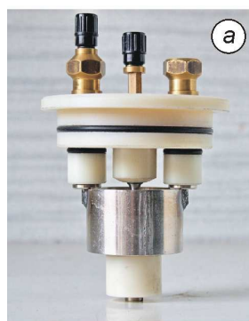
1 – робочий електрод (зразок); 2 – допоміжний електрод; 3 – клемма допоміжного електрода; 4 – клемма робочого електрода
