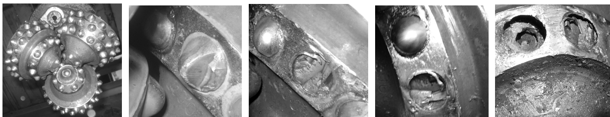
а – через 12 годин роботи долота (загальний вигляд піднесеного над вибоєм долота); б – через 17 годин роботи долота (ділянка вінця шарошки секції № 2; в – те саме через 20 годин роботи долота; г – те саме через 23 години роботи долота; д – те саме через 35 годин роботи долота
