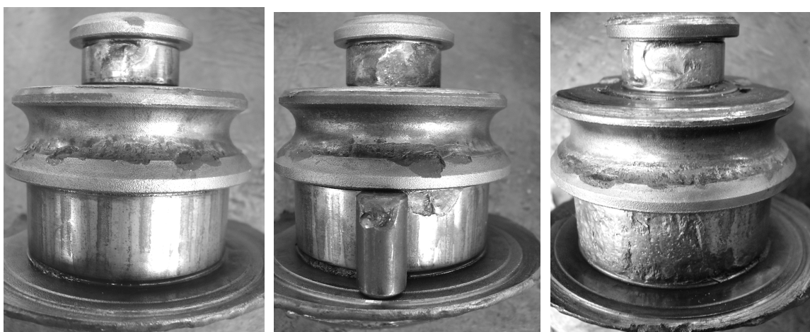
а – цапфа лапи 1 секції; б – цапфа лапи 2 секції та один із зруйнованих роликів на біговій доріжці; в – цапфа лапи 3 секції
