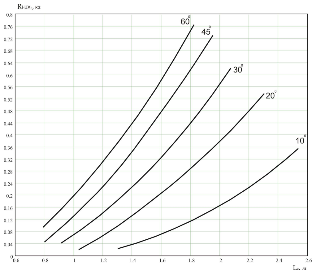
Рисунок 7 – Залежність зміни реакції на верхньому ОЦЕ від відстані між ними для двоопорної моделі КНБК при r_n=0.2 мм
