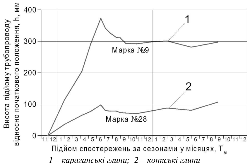
Рисунок 4 – Графіки максимальних деформацій поверхневих марок для глин
