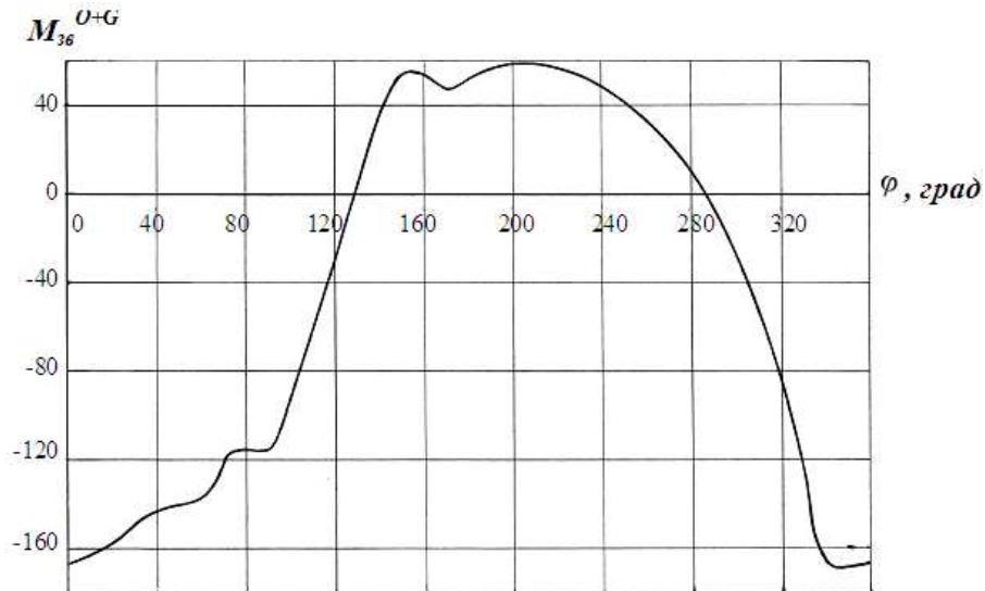
Рисунок 3 – Залежність зведеного моменту сил опору і ваги від кута \varphi
