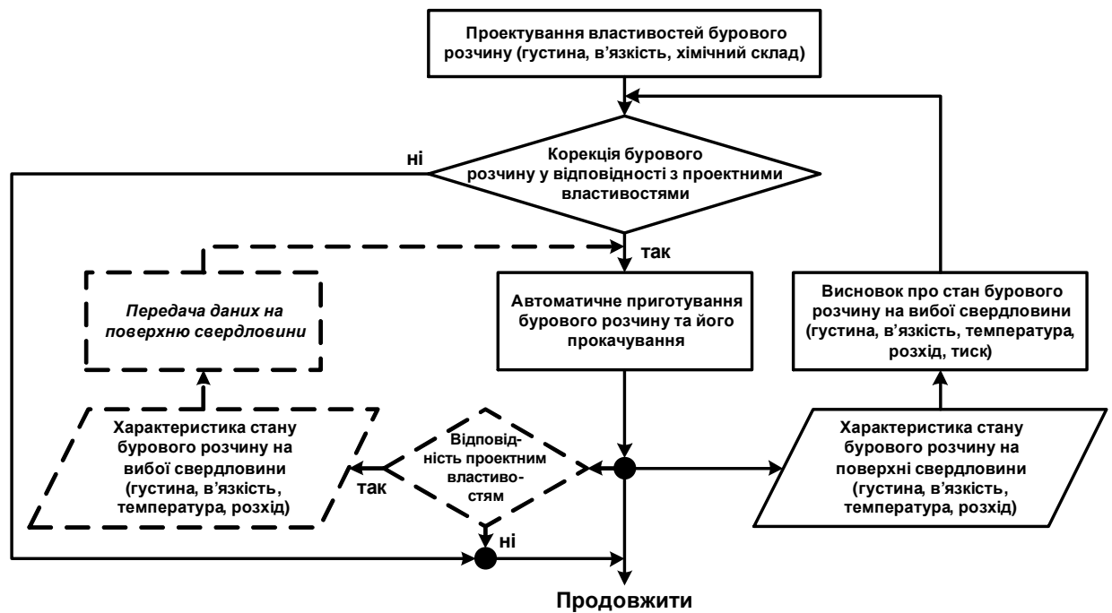
Рисунок 7 – Концептуальна схема інтелектуальної системи контролю бурового розчину
