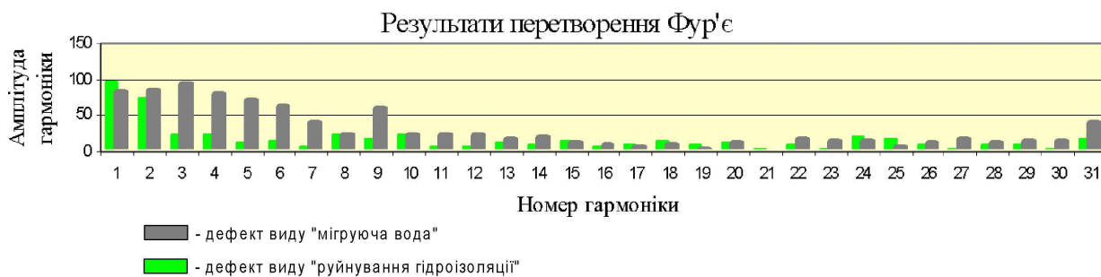
Рисунок 4 – Амплітудні спектри при дефекті виду „мігруюча вода” та „руйнування гідроізоляції”
