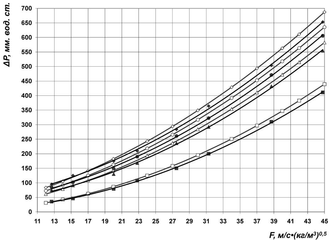
Рисунок 5 – Порівняння експериментальних даних за гідравлічним опором з розрахунковими для ПВСЕ з ТЦ-завихрювачем ( $\Phi^* = 0,65$ )
