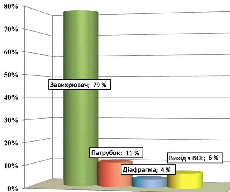
Рисунок 6 – Частка гідравлічних опорів окремих конструктивних складових сепараційного елемента в загальному опорі ПВСЕ
