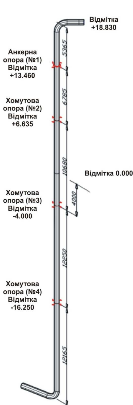
Рисунок 3 – Просторова розрахункова модель стояка
