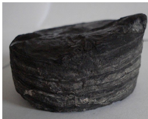
Рисунок 6 – Керн чорносланцевих порід спаської світи з інтервалу 5280-5286 м (Орівська скиба) з Опорної свердловини Шевченкове-1
