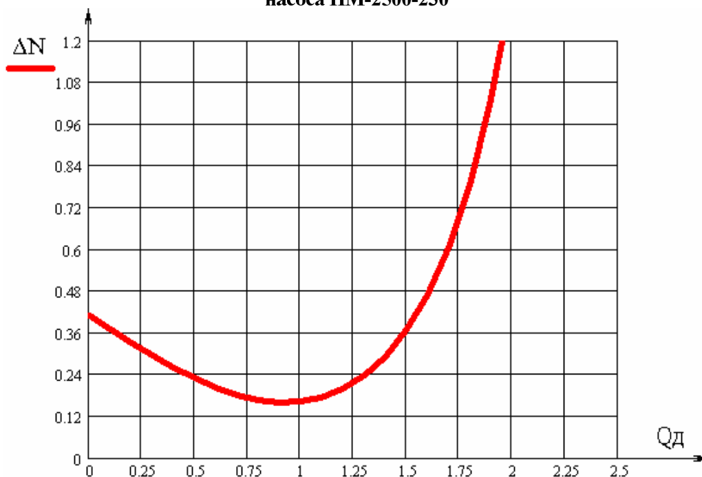
Рисунок 8 — Характеристика втрат потужності насоса НМ-2500-230
