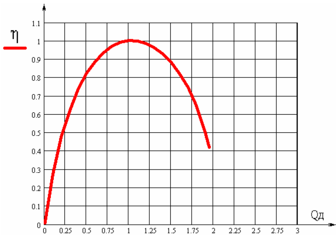
Рисунок 9 — Залежність ККД насоса НМ-2500-230
