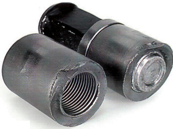
Рисунок 7 — Поломки муфти від втрати затягнення різьбового з'єднання
