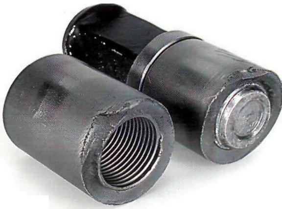
**Рисунок 7 — Поломки муфти від втрати затягнення різьбового з'єднання**
