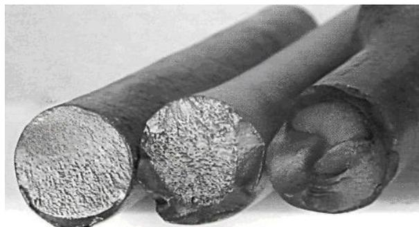
Рисунок 5 — Втомні поломки штанг по тілу від згину
