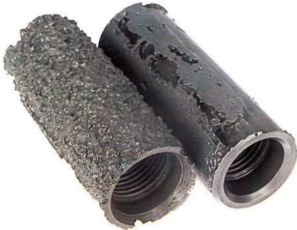
Рисунок 8 — Типові приклади \text{CO}_2 -корозії на муфтах
