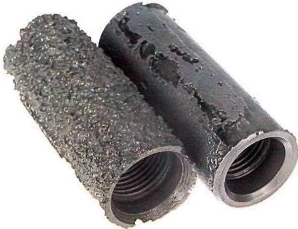
Рисунок 8 — Типові приклади  $\text{CO}_2$ -корозії на муфтах
