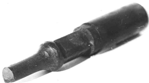
Рисунок 4 — Механічна поломка штанги
