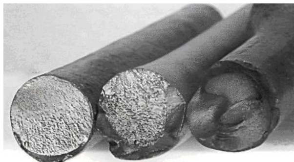
Рисунок 5 — Втомні поломки штанг по тілу від згину
