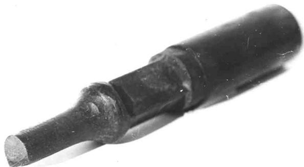
Рисунок 4 — Механічна поломка штанги
