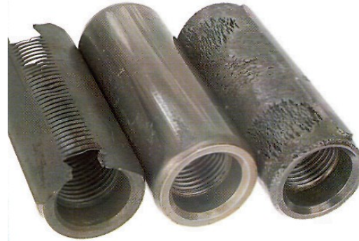
Рисунок 2 — Поломки і пошкодження насосних штанг і муфт
