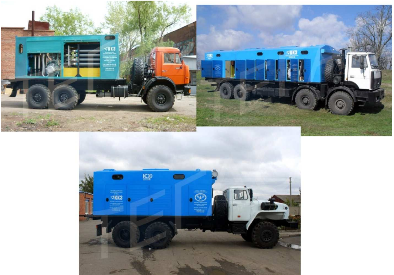
Рисунок 7 – Азотні газогенераторні установки на базі автомобільних шасі
