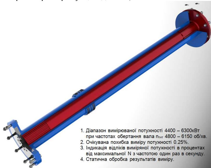
Рисунок 2 – Вимірювач потужності торсійного типу на основі мікроконтролера PIC16F84
