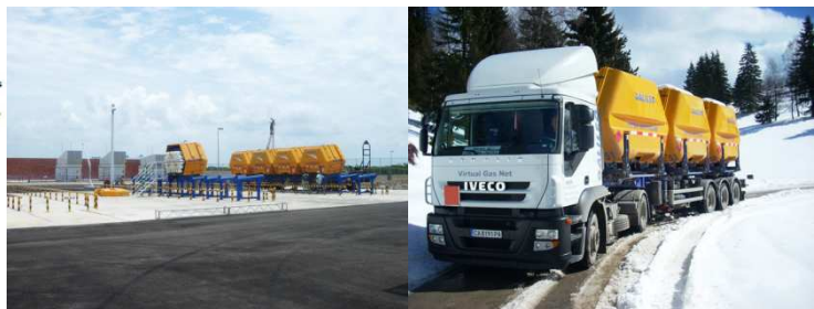
Рисунок 6 – Технологія «Віртуальна труба» та обладнання фірми Galileo
